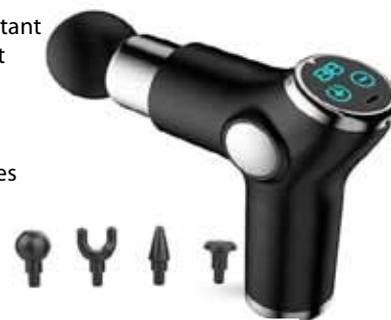
▲Caractéristiques : réglable de 1200 à 3200 percussions par minute, choix de 32 intensités de percussions réglables, silencieux, poids 0.470 kg, 4 têtes de massage fournies, câble USB, batterie lithium haute autonomie 2 heures de travail, écran LCD.
